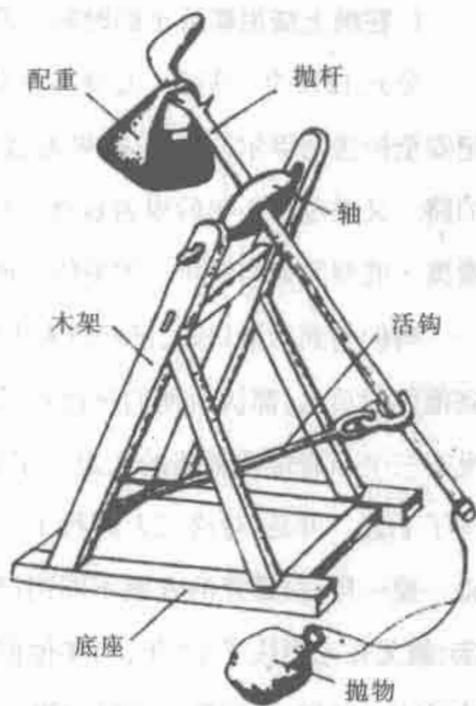
元朝的回回炮结构图
